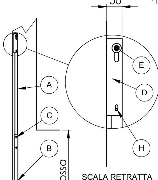
Fissata la scala in posizione, rimuovere la lamiera di spessoramento. Il perno (E) deve avere la possibilità di scorrere verso l'alto di qualche millimetro per agevolare il movimento della scala sia in apertura che in chiusura.
